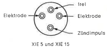
Bild 2 Sockelanschlüsse (Ansicht von unten)
